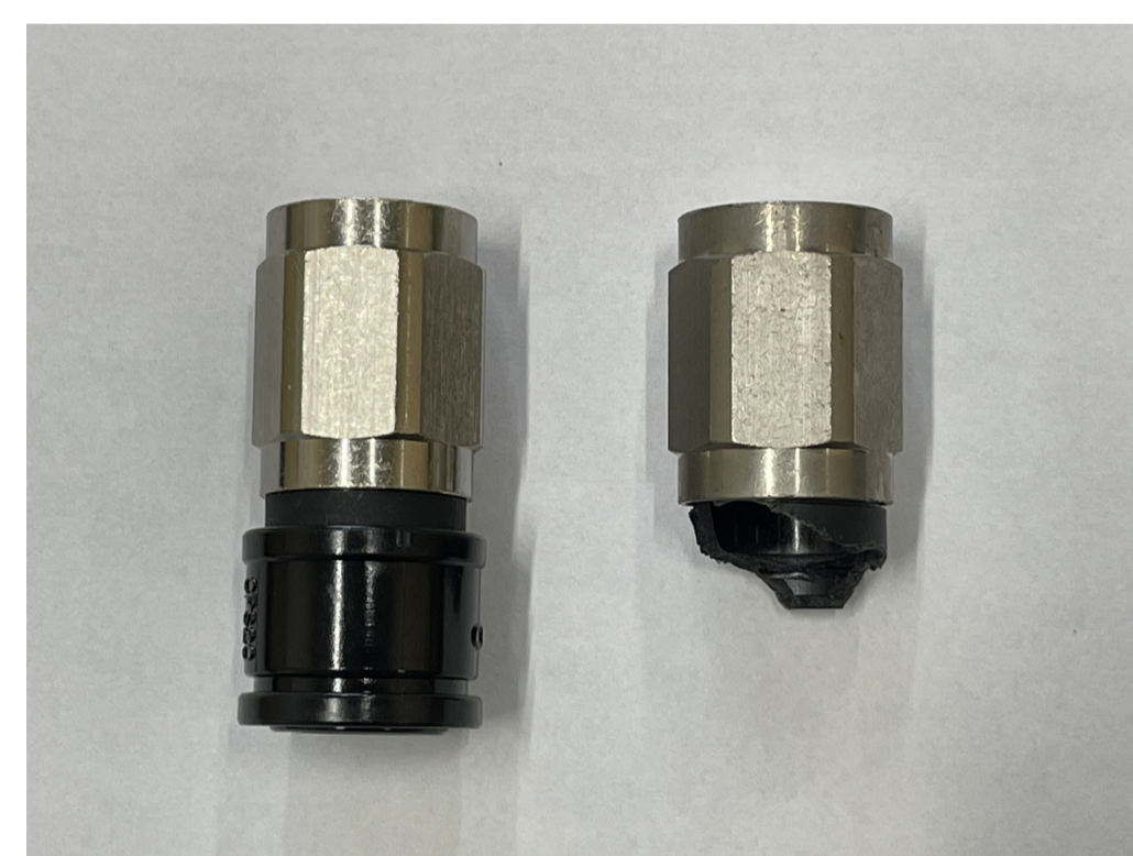
※左側が破損前・右側が破損後
